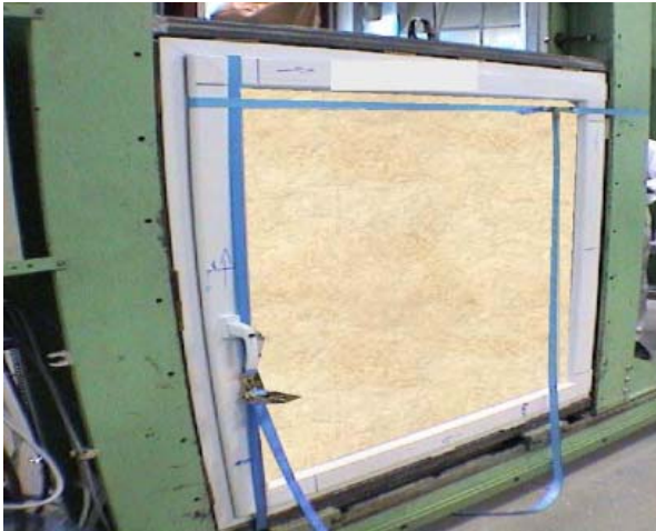
Bild 1: Statische Prüfung mit zusätzlichen, über Gurte eingebrachte Belastungen (additional loading test)
